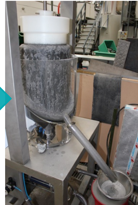
Pneumatische Flotationszelle Imhof 25L, Baryt-Konzentrat, Inbetriebnahme, IFAD, April 2017
