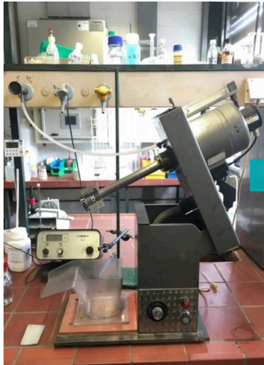
3x Rührwerk-Laborzelle Denver 0,5-1L, Testzelle für Basisuntersuchungen, IFAD, Juni 2016
