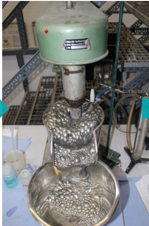
Rührwerk-Laborzelle Denver 3L, Sulfid-Konzentrat für Laugeversuche, IFAD, Januar 2017
